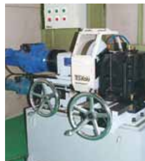
▲ 溶接部開先加工機
