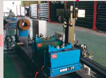
▲ 拡翼取付部プラズマ自動切断機械
