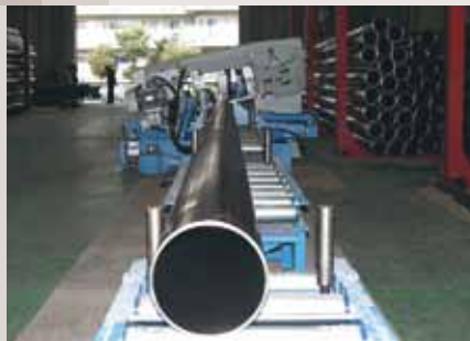
▲ 自動パイプ切断機械
