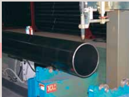
▲ 拡翼取付部切断前
