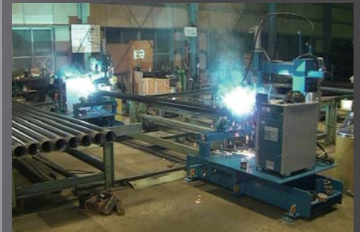
安定した品質を実現する 自動溶接機
