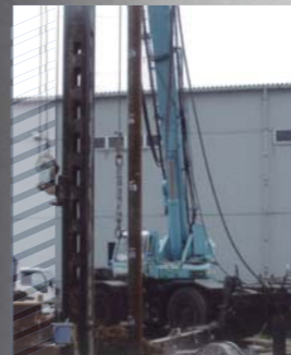
ホイールクレーン式杭打ち機
